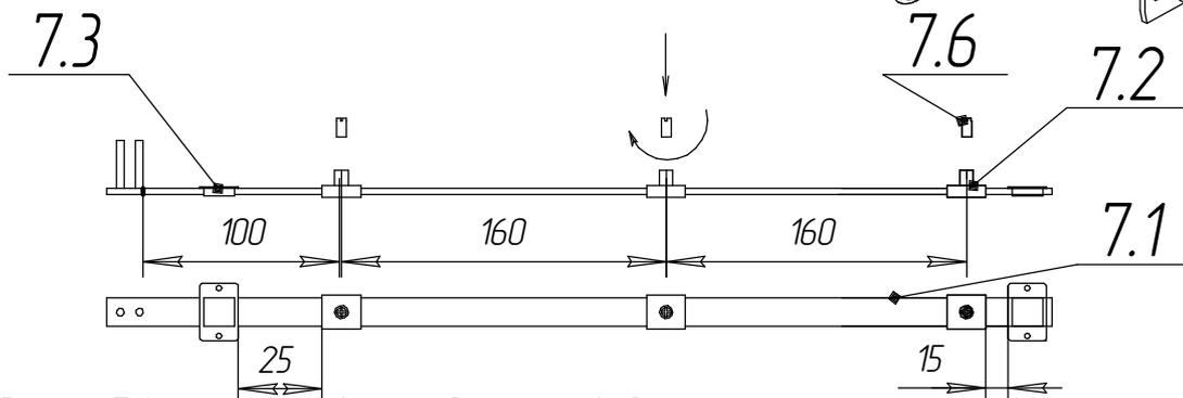
Винты 7.6 зажать отверткой по часовой стрелке
