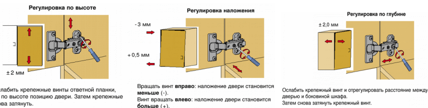
Рис.3 Схема регулировки петель
