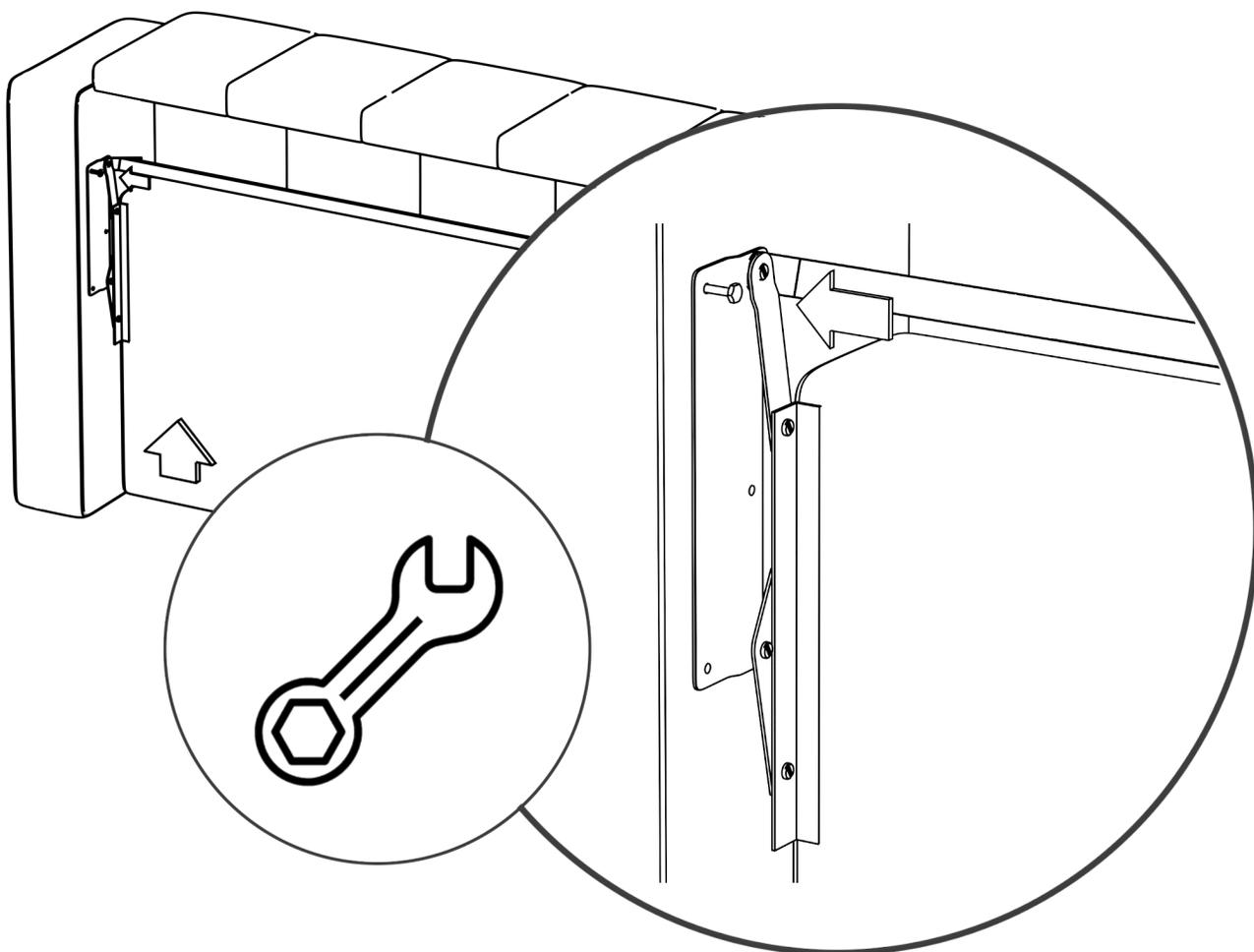
4. Приподняв механизм посадочного места укрепить верхнюю часть с помощью болта М8 (ключ 13) с обеих сторон.
