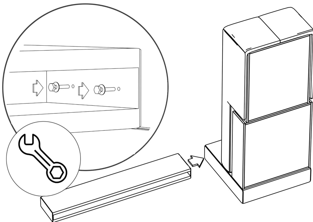
2. Слева от оттоманки, на полу, устанавливаем фальш спинку, крепим к оттоманке с помощью двух болтов М8 (ключ 13)
